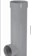
インポート立管部の自由な位置にホールソーを用いて穿孔し、VT用支管を接着合着します。(最小落差5cm)
